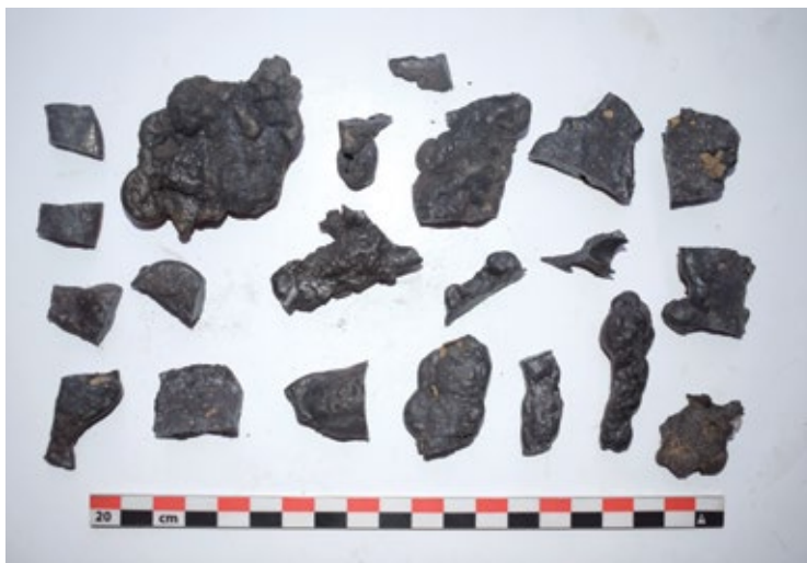
Slika 9: Komadi talioničke zgure koji nastaju ispuštanjem zgure iz peći (snimio I. Valent)
