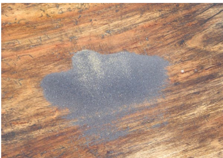
Slika 4. Nakon što je teška frakcija na drvenom pladnju dodatno ispirana u čistom koncentratu vide se jasno zrnca zлата već prostim okom. Ovisno o broju zrnaca ispirać odlučuje da li će na tom mjestu nastaviti radom ili će potražiti neko drugo bolje mjesto
