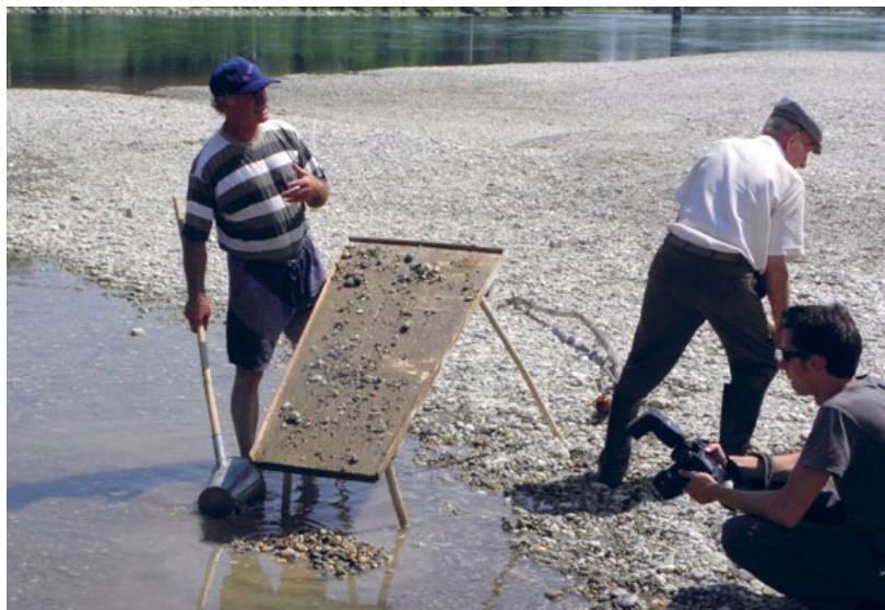
Slika 2: Stol za odvajanje lakše frakcije iz nanosa Drave. Na stolu zbog nagiba i urezanih zareza voda istjeruje lagane minerale, a na daski stola ostaju zrnca teških minerala. Sitna zrnca teških minerala zaustavljaju se na ukrštenim zarezima urezanim u drvenu podlogu (prizor s ispiranja zlata kod Donje Dubrave 2013., zlatari Stjepan Matotek i Matej Horvat)
