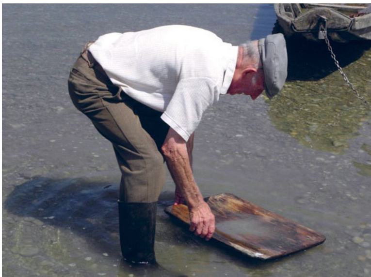
Slika 3. Stari ispirać zлата na Dravi Matej Horvat iz Donjeg Vidovca sakupio je teške minerale sa stola za ispiranje u plitku drvenu tacu u kojoj pročišćava teške minerale od sitnih čestica gline i eventualnih iverja drveta od stola. Taj posao se obavlja u nekoj plitkoj i mirnijoj uvali rijeke
